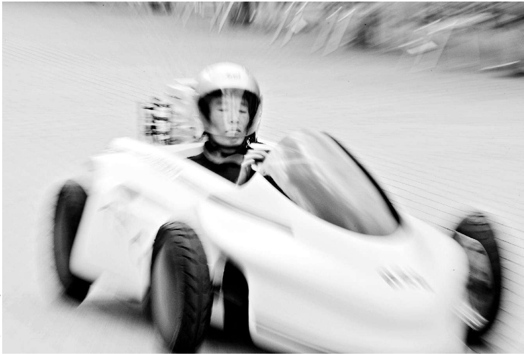
Wärmewandler: Dieser kleine Einsitzer fährt mit einem thermoelektrischen Generator, der Wärme in elektrische Energie verwandelt. Entwickelt wurde das Gefährt von Toshiba. Der Elektronik-Hersteller präsentierte den kleinen Flitzer mit dem Namen „Thermo Electric Generation Vehicle“ (TEGV) im Mai 2008 an der Osaka-Sangyo-Universität in Daito.
