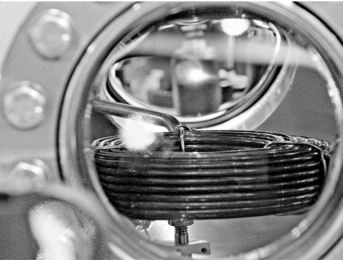
Die Vakuumkammer der Braunschweiger Gitteruhr: Unter dem leuchtenden Strahl von Strontium-Atomen ist die ultrakalte Wolke gefangener Atome zu sehen.
