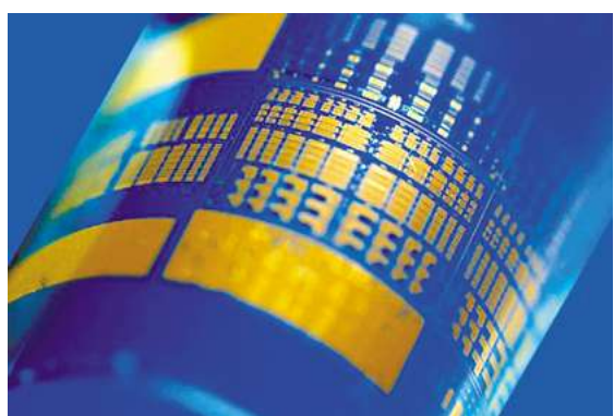
Inspiziert vom menschlichen Auge: Der gekrümmte Lichtsensor der Forscher aus Wisconsin besteht aus Nano-Schichten des Halbleiters Germanium.
