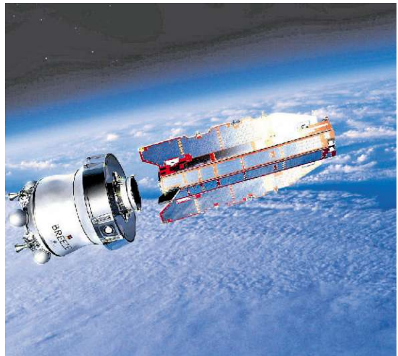
Computeranimation des Esa-Satelliten GOCE. Aufgrund seiner geringen Flughöhe ist er mit kleinen Flossen ausgestattet.
