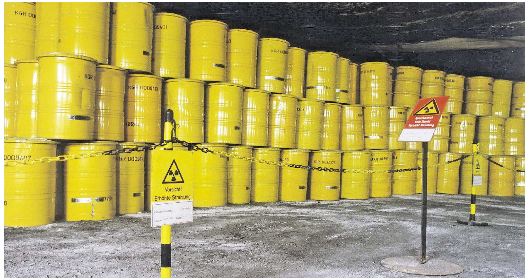
Strahlende Zukunft: Im Endlager Morsleben lagern über 36 000 Kubikmeter schwach- und mittelradioaktive Abfälle. Für hochradioaktive Substanzen gibt es bis heute noch keine Endlager.
