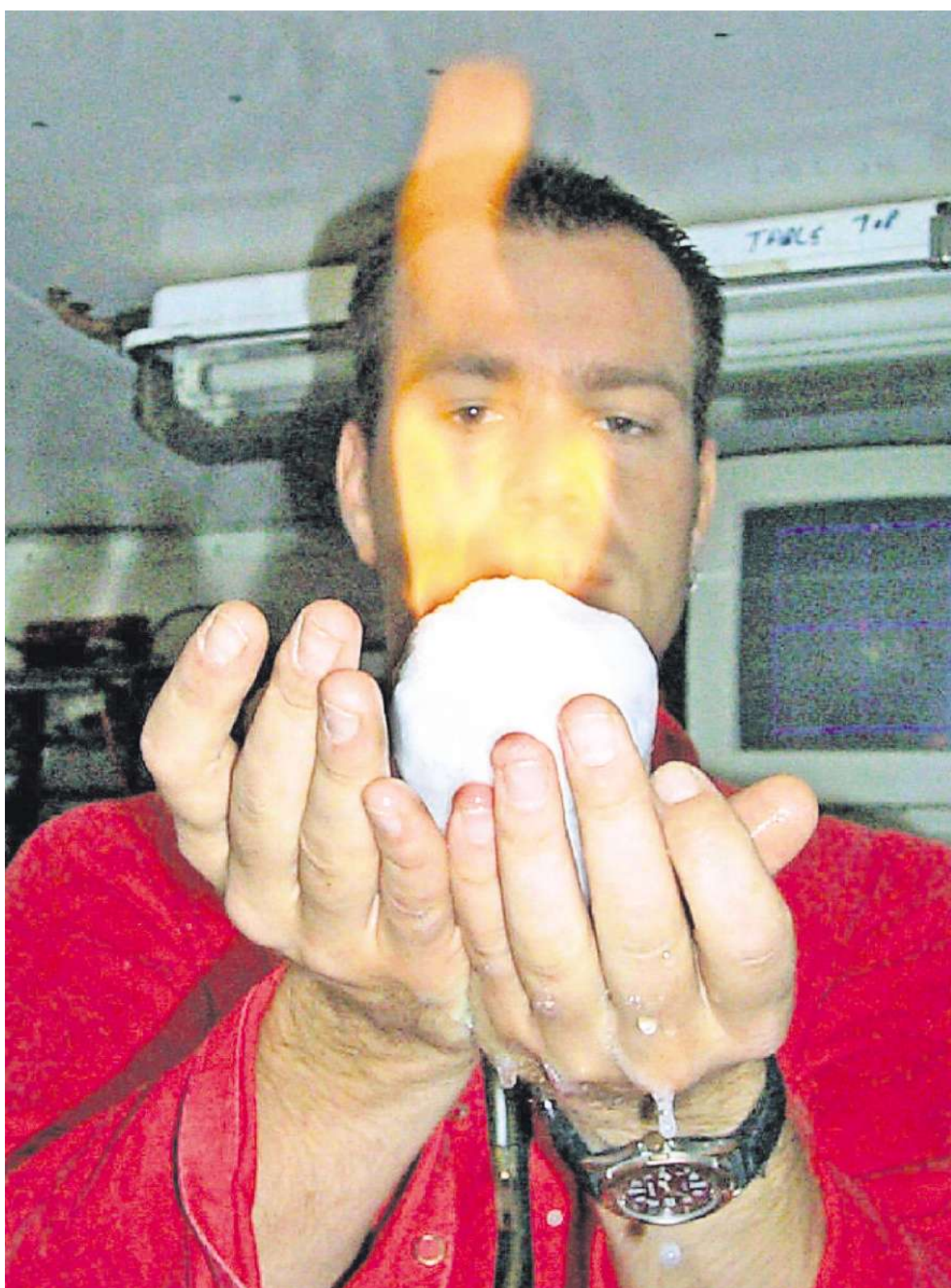
Bei Zimmertemperatur entweicht das Methan aus dem Eis und lässt sich entzünden.
