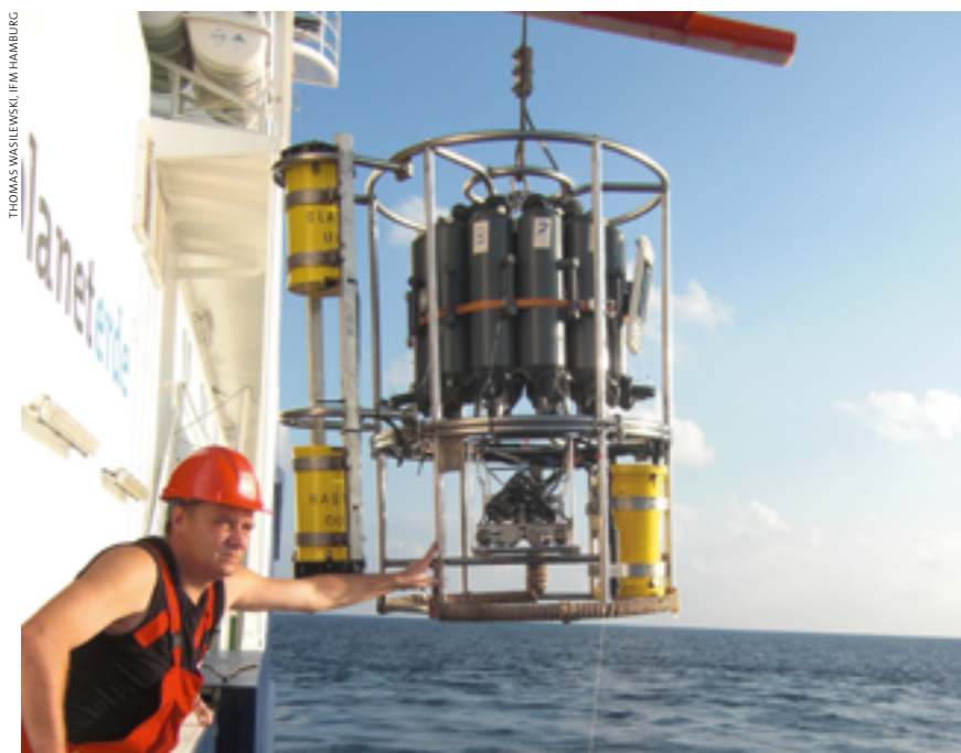
Als Instrumente zur Vermessung des Golfstroms dienten auch so genannte CDT-Rosetten (von englisch Conductivity, Temperature, Depth , »Leitfähigkeit, Temperatur, Tiefe«). Sie sind mit Sensoren für Temperatur, Leitfähigkeit und Wasserdruck bestückt. Aus diesen Messwerten lassen sich außerdem Salzgehalt und Wassertiefe ableiten. Eine solche Rosette wird hier von der Meteor ausgesetzt. Zusätzlich enthält sie in den gelben Röhren je ein ADCP-Gerät, das ein Tiefenprofil der Strömungen liefert.
